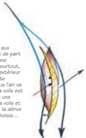
Sur un bateau à voile qui navigue plutôt contre le vent, on dira *au près* : ce vent exerce une attraction perpendiculaire au plan de la voile. L'effet de cette poussée, n'allant pas dans la direction que l'on souhaite, il est corrigé par l'action de la « *dérive* ».
