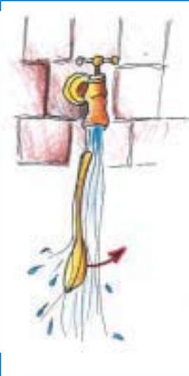
*Celle-ci est attirée vers la partie sur laquelle coule le filet d'eau à cause de la différence de pression entre ses deux côtés. Elle va donc du côté bombé. La face creuse de la cuillère est en dépression par rapport à la face convexe, exactement comme l'air qui soufflant dans une voile a tendance à aller des hautes vers les basses pressions.*
