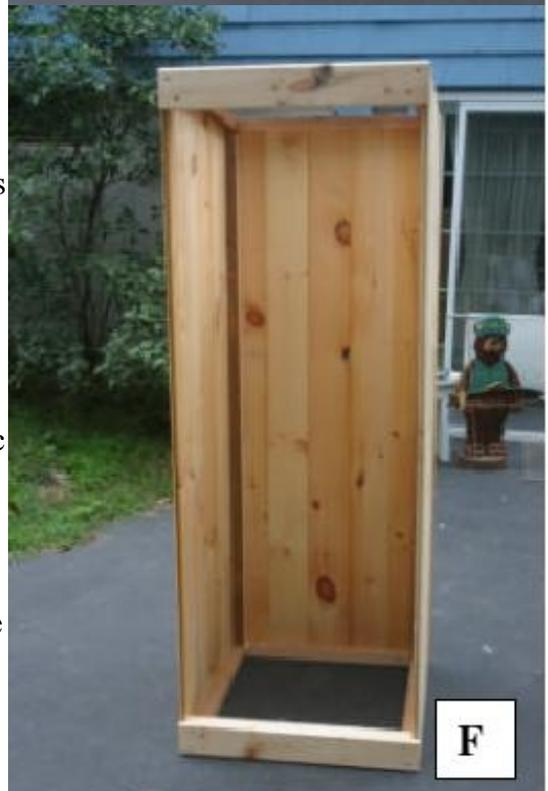
Huit supports d'étagères en tasseau de 38 x 38 mm seront nécessaires à raison de 4 par panneau placés à l'intérieur de ces panneaux. Le dessus du premier a été placé à 46 cm du sol et le dessus des autres sont écartés de 35.5 cm (photos & G Annexe-Fig 1).
