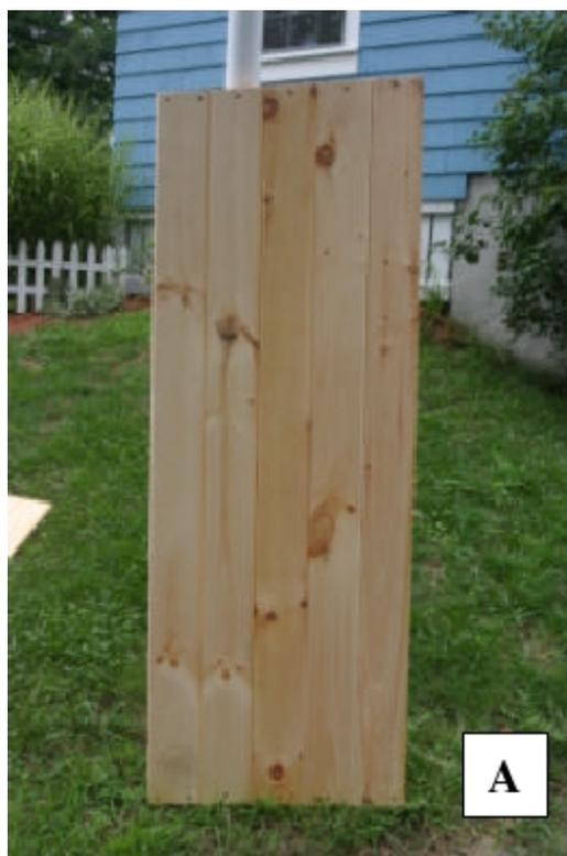
Pour les panneaux des côtés on a assemblé 5 lames en faisant en sorte que la tranche rainurée soit vers l'avant et l'autre tranche sur laquelle on a supprimé la languette vers l'arrière.
