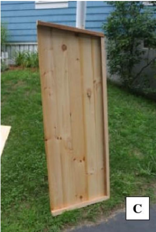
Le panneau du fond résulte de l'assemblage de 5 lames coupées ensuite à la hauteur de 175 cm. Des carrelets sont venus se fixer en haut et en bas de façon à s'adapter au carrelets placés sur les bords arrière des côtés
